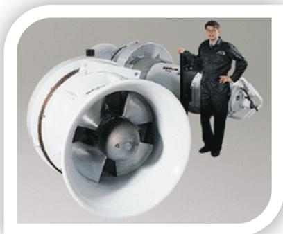
Областью применения погружных насосов с осевым входом является перекачка необработанной воды, прокачка сточных вод для очистных сооружений, перекачка морской воды, перемешивание воды в различных системах водоподготовки. Данные насосы используются в разнообразных ирригационных системах. Широкое применение имеют они и во многих других отраслях промышленности, сельского хозяйства, в строительстве.
