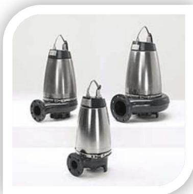
Область применения данной серии насосов применения очень широка. Погружные насосы SEV и SE1 предназначены для перекачивания сточных вод в муниципальных, частных и промышленных системах, в том числе стоки, содержащие фекалии. Они перекачивают жидкость, содержащую включения размером до 100 мм. Конструкция этих насосов сводит к минимуму возможность блокировки или засорения, а также простои оборудования из-за технического обслуживания.
